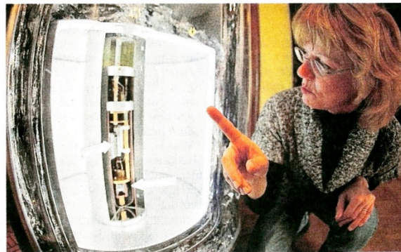
Ingenieurin Ilona Nowak vom Bundesamt für Kartografie und Geodäsie erklärt an einem Modell die Funktion eines Gravimeters. Mit dem Gerät wird die Schwerebeschleunigung, eine besondere Art zur Bestimmung der Masse eines Körpers, gemessen. Die Methode erlaubt Rückschlüsse auf die Erdrotationsgeschwindigkeit. „Freie Presse“, 30. 12. 2010 FOTO: MARIO VEDDER/DAPD
